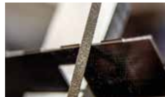
Obr. 6: Srážení hran (odstraňování gródu) ručně = delší přípravné časy
