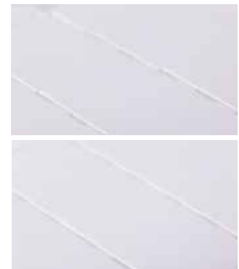
Obr. 5: Porovnání dvou seků vyskládané linky rill/nůž a speciální kombilinky
