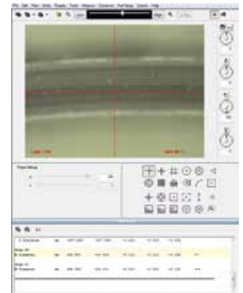
Zvětšení nože přes ostří a zaměření ostří osovým křížem. Ve spodní části: Vytváření výstupního protokolu
